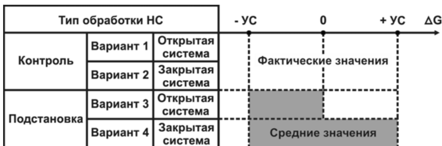
Рисунок 3.26 – Алгоритм работы вычислителя для различных вариантов значений параметра Тип контроля
