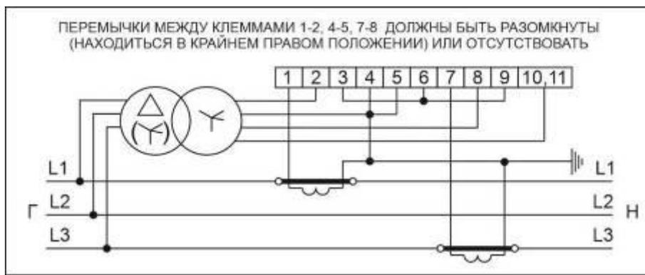
Рисунок Б.5 – Схема включения счетчиков в корпусах W31 трансформаторного включения через три трансформатора напряжения и два трансформатора тока
