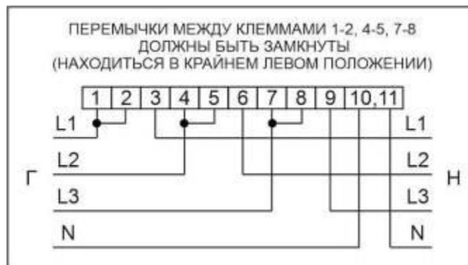
Рисунок Б.2 – Схема включения счетчиков в корпусе W31 непосредственного включения на измерительных элементах трансформаторов тока
