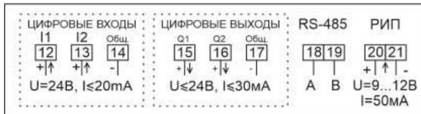
Рисунок Б.18 – Схема включения сигнальных цепей счетчиков в корпусе W31 с интерфейсом RS-485
