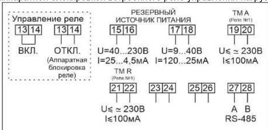
Рисунок Б.35 – Схема включения сигнальных цепей счетчиков в корпусе W32 с интерфейсом RS-485, с двумя дискретными выходами, входом для подключения резервного источника питания, и аппаратной блокировкой встроенного реле управления нагрузкой (с помощью клеммника)
