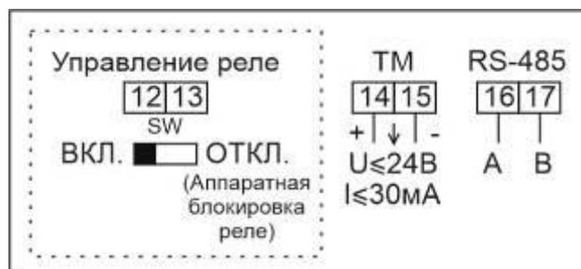
Рисунок Б.20 – Схема включения сигнальных цепей счетчиков в корпусе W31 с интерфейсом RS-485 с одним дискретным выходом, настроенным как телеметрический выход и аппаратной блокировкой встроенного реле управления нагрузкой (с помощью микропереключателя)
