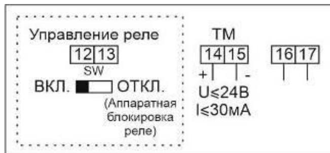
Рисунок Б.19 – Схема включения сигнальных цепей счетчиков в корпусе W31 с одним дискретным выходом, настроенным как телеметрический выход, и аппаратной блокировкой встроенного реле управления нагрузкой (с помощью микропереключателя)
