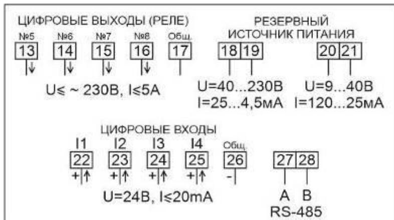
Рисунок B.33 – Схема включения сигнальных цепей счетчиков в корпусе W32 с интерфейсом RS-485, с четырьмя дискретными выходами и с четырьмя дискретными входами, входом для подключения резервного источника питания
