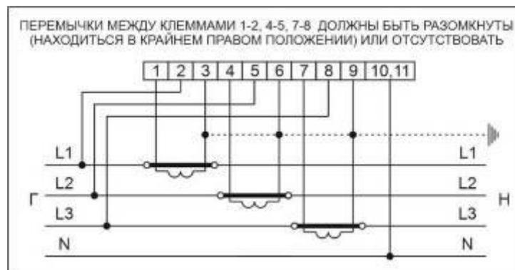
Рисунок Б.3 – Схема включения счетчиков в корпусах W31 и D33 трансформаторного включения через три трансформатора тока
