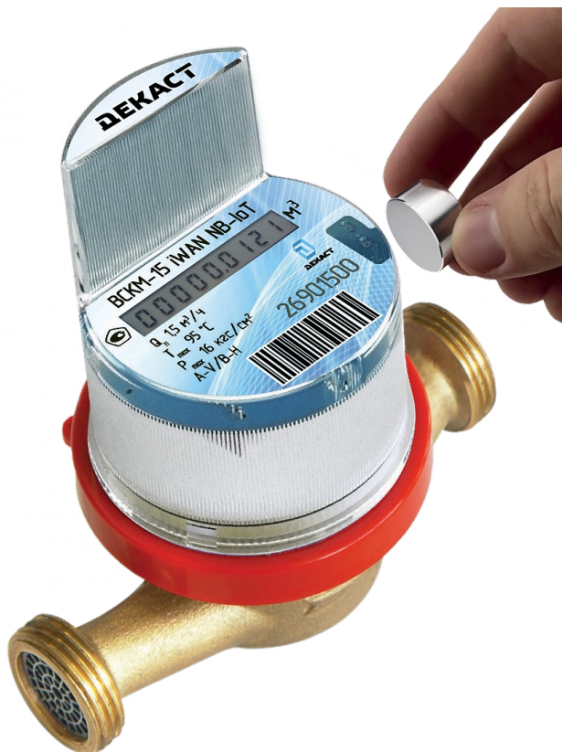
Рис. 3 Место для воздействия магнитом на счетчик
